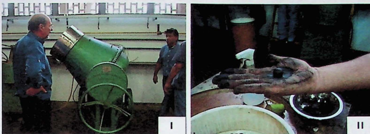
Figura 5: Processo de pelletização do minério de ferro de Bodoquena. (I) Pelotizador tradicional, adaptado em uma betoneira rotativa; (II) Pelotas auto-redutoras feitas à mão;
