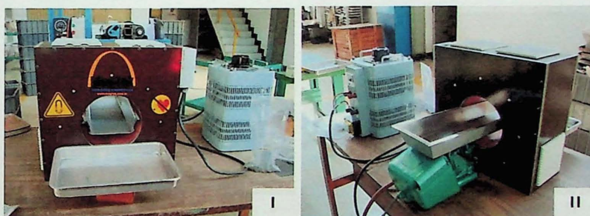
Figura 21: Processo de desmagnetização. Amostra BDQ-TR; (I) Desmagnetizador por corrente alternada Magtek Túnel ITDT-C; (II) Alimentação por calha vibratória: velocidade de 10 cm/s;
