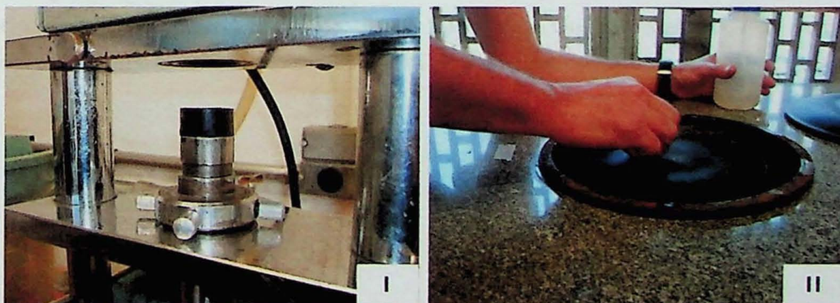
Figura 8: Pelotas embutidas para metalografia; (I) Pelota convencional embutida a quente em braquelite; (II) Pelota embutida em resina Epoxiglass e polida em pano diamantado;
