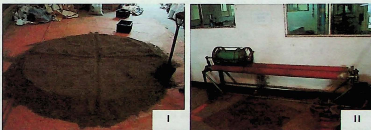
Figura 17: Processamento inicial do minério de ferro retirado de trincheiras na região de Bodoquena, MS. Amostra BDQ-TR; (I) Homogeneização e quarteamento manual (II) Moinho de barras/bolas. Sistema a úmido (70% em massa);
