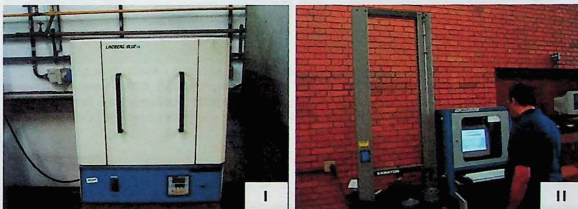
Figura 6: Equipamentos utilizados no processo de queima das pelotas de minério de ferro. (I) Forno (mufla) de resistência Lindberg/Blue M; (II) Prensa de ensaio universal KRATOS v1.0 para ensaio de compressão a frio;
