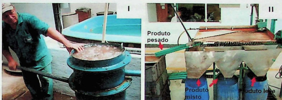
Figura 15: Processos visando separação por densidade. (I) Jigge manual para separação gravimétrica em lump feed ( \pm 1'' ); furo FAES 01; (II) Mesa concentradora para separação gravimétrica em sinter/pellet feed (100 mesh ); furo FAES 01;
