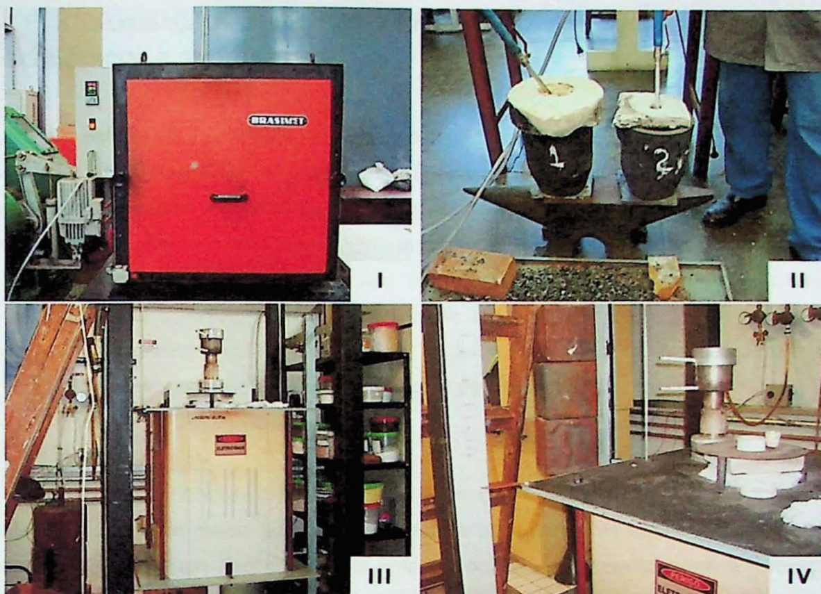
Figura 7: Equipamentos utilizados na redução do minério de ferro; (I) Forno de tratamento térmico Brasimet K 400; (II) Resfriamento com auxílio de nitrogênio para evitar a oxidação; (III) Forno vertical Lindberg/Blue adaptado para ensaios termogravimétricos em pelotas auto-redutoras; (IV) Detalhe da abertura do forno vertical e do cadinho de alumina;
